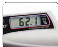
③2秒後にサンプルの Brixを表示します
