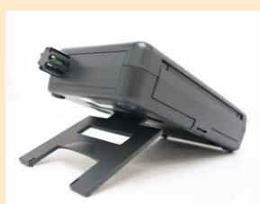
SDカードのみをパソコンに持ってくれれば、データがエクセル形式で表示されます。市販のSDカードが使用でき、PCとのケーブル接続の必要もなく、データ移動も簡単です。
