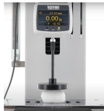
クッション性のある素材や圧入部品などを押し込む際、グラフを作成して荷重値の変化を評価することができます。押し込み量に対して荷重値の推移を見ることはもちろん、グラフ上の特定の変位値における荷重値の検索やコメント挿入が簡単にできます。
