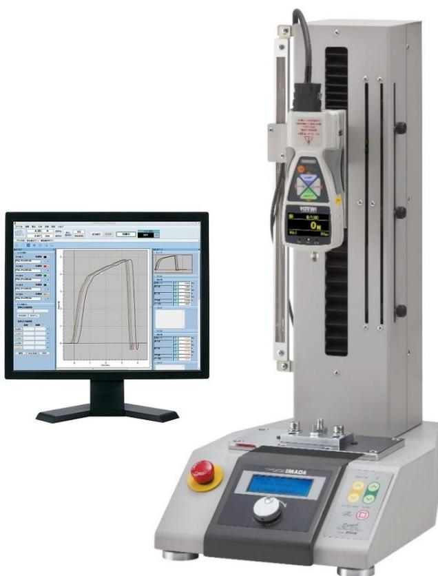
FSA シリーズは、フォースゲージ・計測スタンド・ソフトウェアなど関連製品がセットになった荷重-変位測定用ユニットです。
