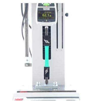
サンプルが破壊されるまでの過程をグラフ化することができます。破断に至るまでや破断時の荷重変化が視覚的に確認できます。また、破断発生時のピーク荷重や特定の荷重・変位値を検索してコメント挿入することができます。
