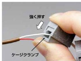
② 矢印の方向にコネクタを押しながらケージクランプ側に線が突き当たるまで差し込みます。コネクタを離し結線させます。
