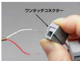
① ケーブル先端の外装被覆と内装被覆を剥いでリード線を出し、ワンタッチコネクタに接続します。
