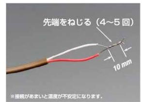
④ ケーブル先端の外装被覆を剥ぎ取りさらに内装被覆を萩剥ぎ、先端をねじります。これが温度センサとなり接点部で温度計測を行います。
