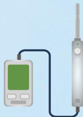
例えば製薬工場や病院など、無線の電波使用に制限のある場所では、一般的な風速計と同様にケーブルを用いた計測が可能です。※ケーブル接続は、表示ユニットのみ対応しています。
