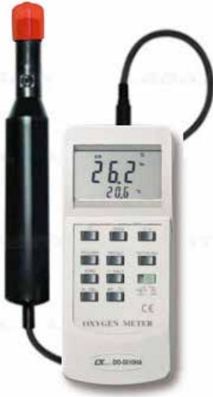
ポーラログラフ式センサーを採用したハンディタイプ溶存酸素計。
